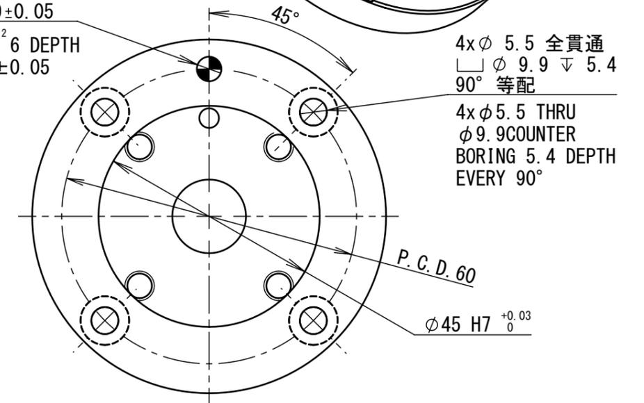
ロボットフランジ取付面
